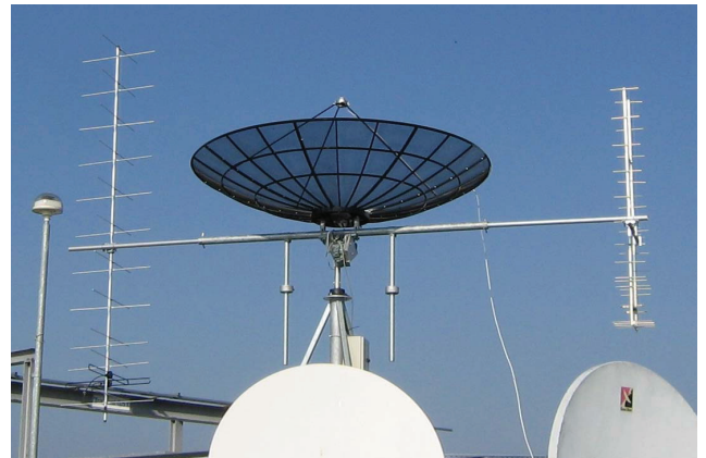
Bodenstation für TUGSAT-1 am Institut für Kommunikationsnetze und Satellitenkommunikation
