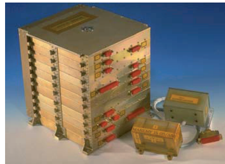
Magnetfeldmeßgerät MAREMF für die Sonde MARS 96
