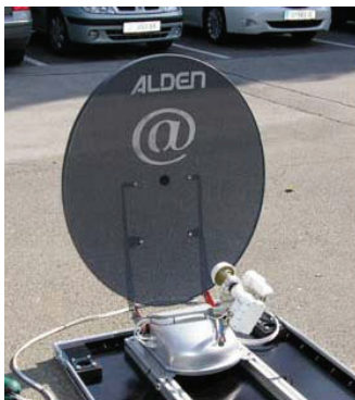
Satelliterminal für Breitband-Internetzugang, Voice over IP und TV mit einer Antenne, die sich vollautomatisch zum Satelliten ausrichtet
