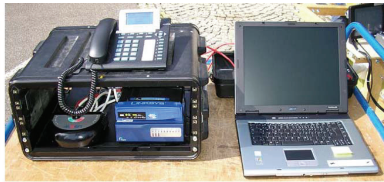
Satelliterminal für Breitband-Internetzugang, Voice over IP und TV mit einer Antenne, die sich vollautomatisch zum Satelliten ausrichtet
