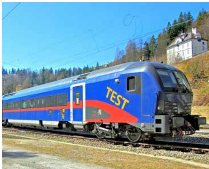
Der Steuerwagen Bfmpz 73 81 80-91 701-0 hat eine „Vectron“-Stirnfront. Im Bild wartet der Probezug mit Steuerwagen voraus im Bahnhof Semmering auf die Abfahrt. Foto: DI Helmut Bogner 14.4.2022
