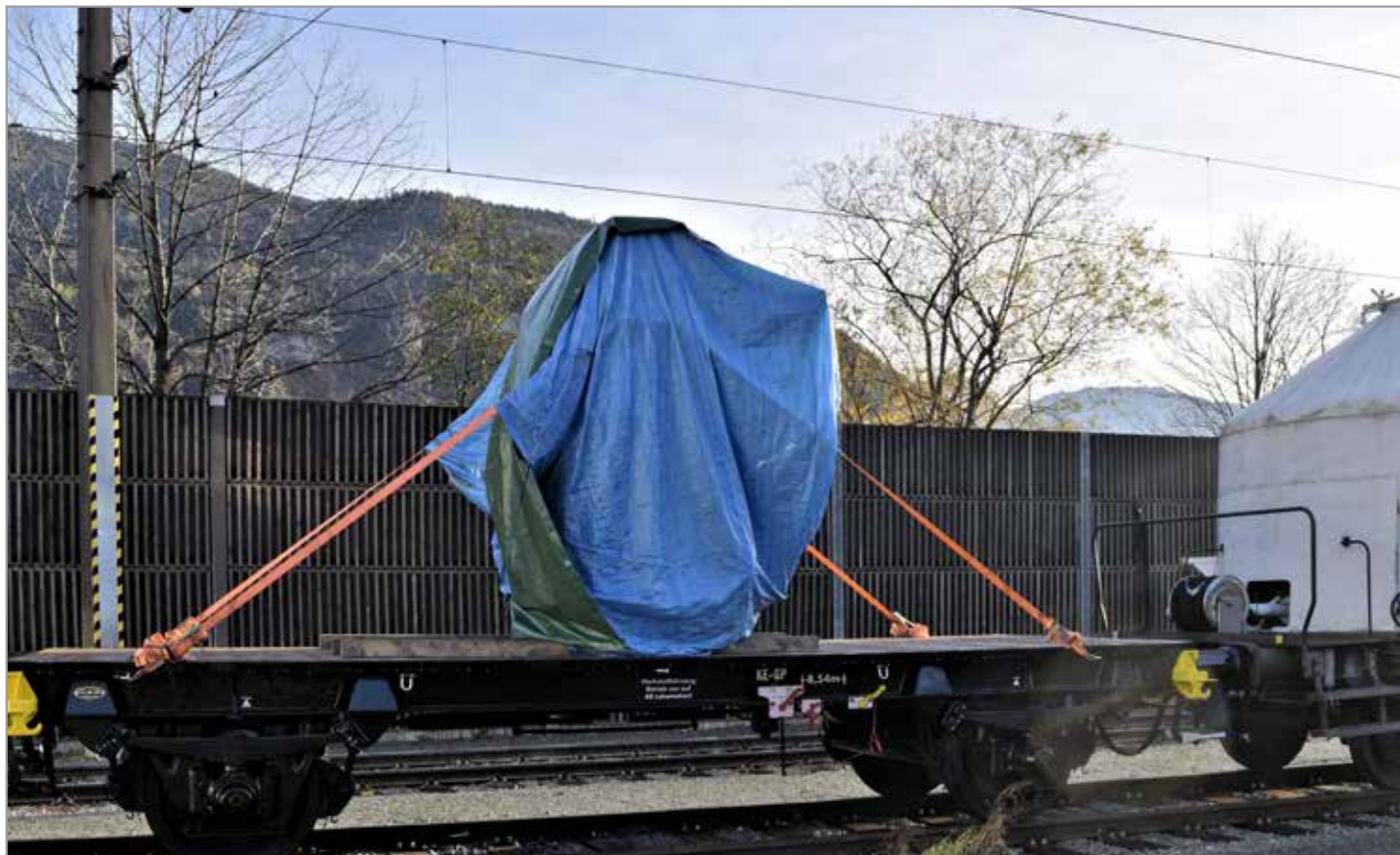
Als Zweites am Haken: ein in Eigenregie restaurierter zweiachsiger Güterwaggon, beladen mit einem „verhüllten“ Transformator aus einer Spenderlokomotive der Baureihe 139
