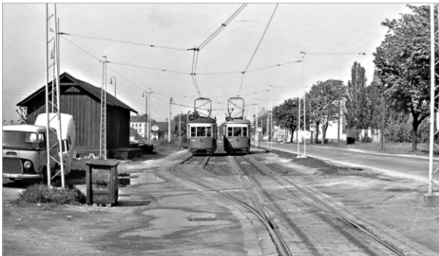
Z 4210 und 4209 begegnen einander am 10.5.1964 knapp nach dem Beginn der Ausweiche Stammersdorf. Gut ist der sogenannte Signaldraht zu erkennen, der das Straßenbahn-Lichtsignal zur Deckung des eingleisigen Abschnittes mit Strom versorgte.
