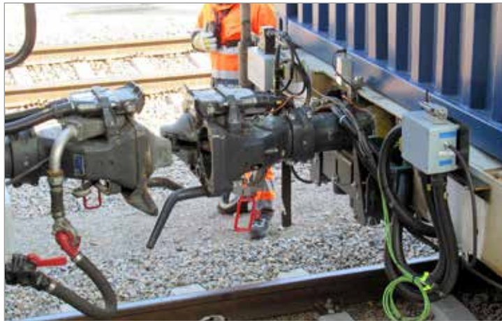
Auf Tastendruck erfolgt die Entkupplung; die roten Griffe sind die Notentriegelung.
