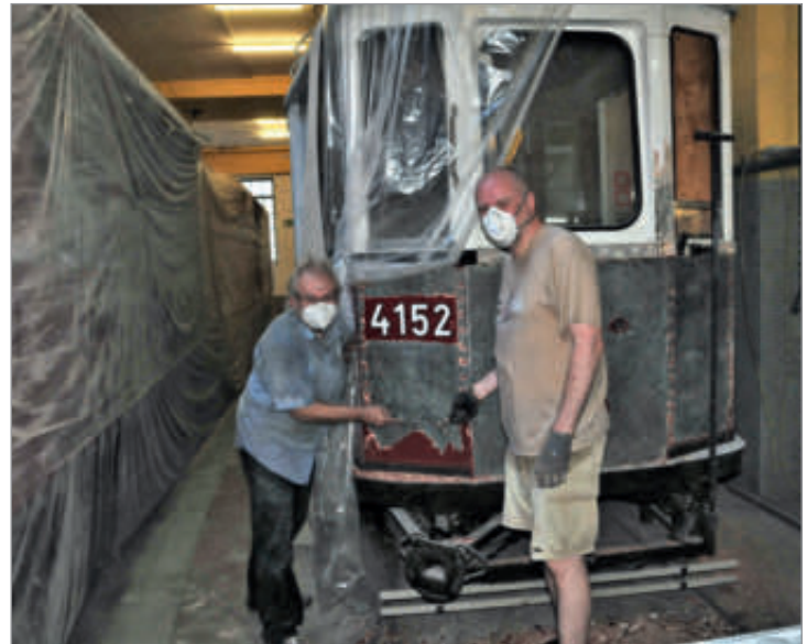
Da ist am 29.6.2021 im wahrsten Sinne des Wortes der Lack ab. Arthur Segur-Cabanc und Roman Lillich beim Abtragen alter Lackschichten. Benachbarte Fahrzeuge wurden gegen Verschmutzung durch Staub mit Plastikfolien abgedeckt. Foto: Mario Fürst, Archiv Roman Lillich
