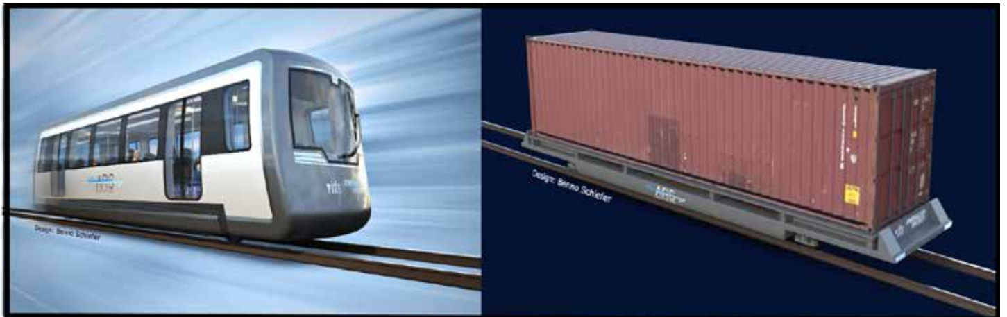
Bild 6: Designstudie des flexiblen, fahrerlosen Schienenbusses mit Fahrgastzelle (links) und als selbstfahrender Container (rechts) © ifs, RWTH Aachen, Design Benno Schiefer.
