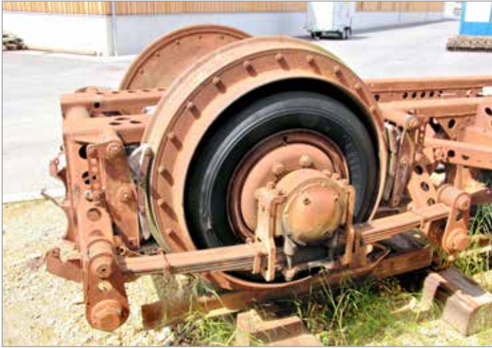
Das erwähnte Drehgestell im Freigelände des Müzzzuschlager Südbahnmuseums. Die Luftreifen sind im Betrieb vollständig aufgepumpt und rollen nicht im Inneren des Eisenbahnrades ab. Wegen des Alters der historischen Reifen hat man aber auf das Aufpumpen verzichtet. Beide Fotos: DI Helmut Bogner, 6.6.2022)
