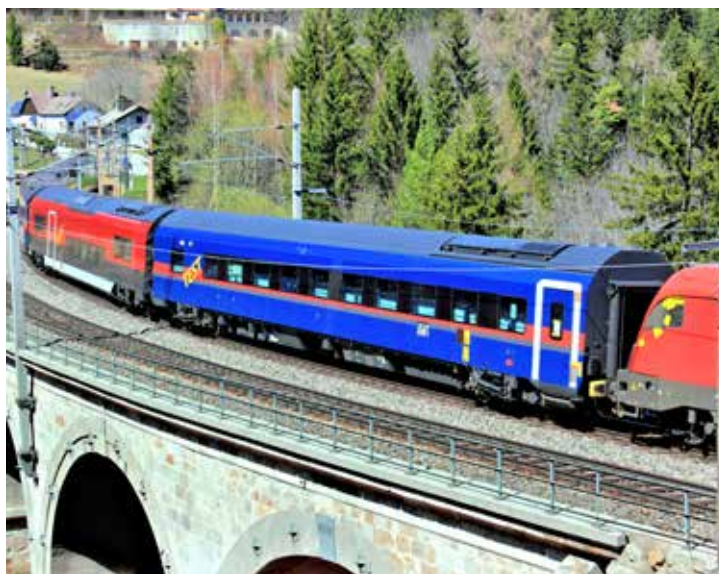
Zur blauen Nightjet-Garnitur gehört der WLAmz/2 73 81 70-91 101-5, der auf der Seite mit der genormten Zug- und Stoßvorrichtung einen normalen Gummiwulstübergang hat, auf der anderen Seite den Übergang der Railjetgarnitur. Im engen Bogen ist die gelbe Kunststoffbeschichtung des Puffers, die das Gleiten bei Bogenfahrten erleichtert, gut erkennbar. Hier überquert er am 13.4.2022 das Kartnerkogelviadukt, links im Bild der Bmpz/1 73 81 22-91 701-1. Foto: Lukas Bogner
