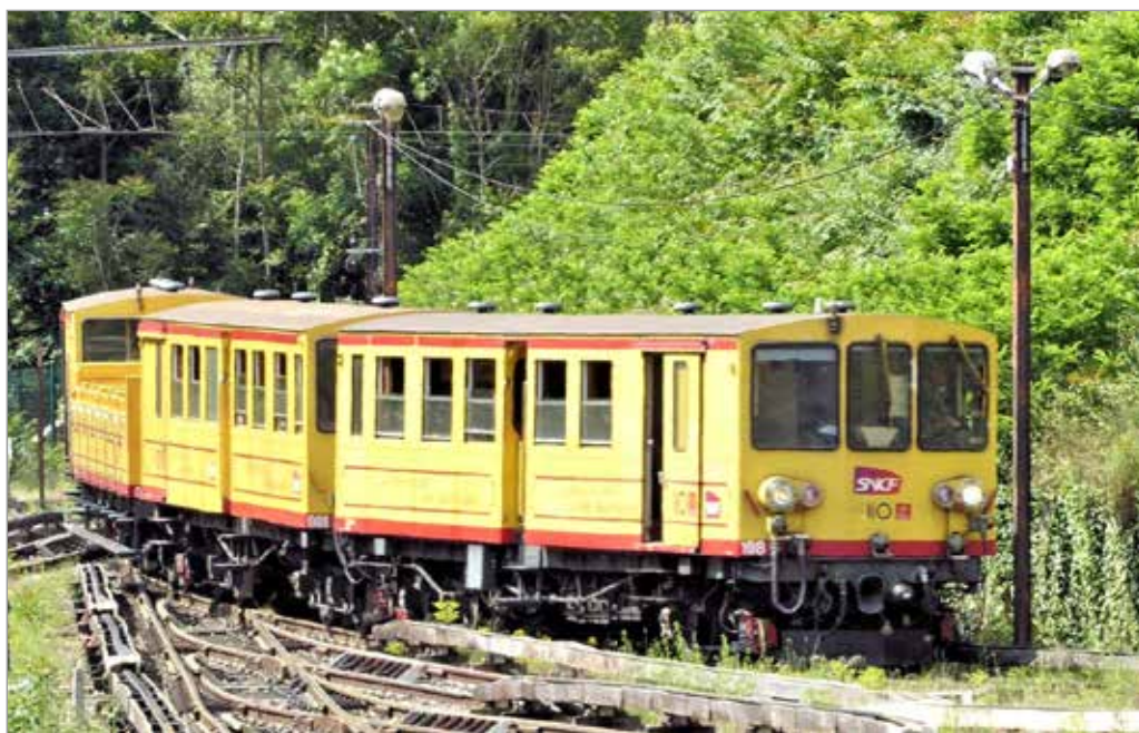
Das Wirrwarr an Meterspurgleisen mit von oben bestrichener Stromschiene in Villedor-Vermet les Bains.
