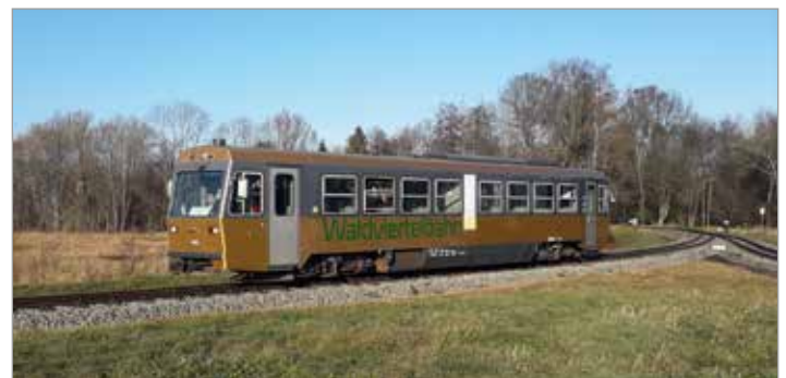
In der Morgensonne posiert der VT8 am Gleisdreieck in Gmünd vor den Fotografen. Dieses dient zum Wenden der Fahrzeuge um den Spurkranzverschleiß zu vergleichmäßigen. An der Baumreihe im Hintergrund, welche die tschechische Grenze markiert, befindet sich der Gleisabschluss.
