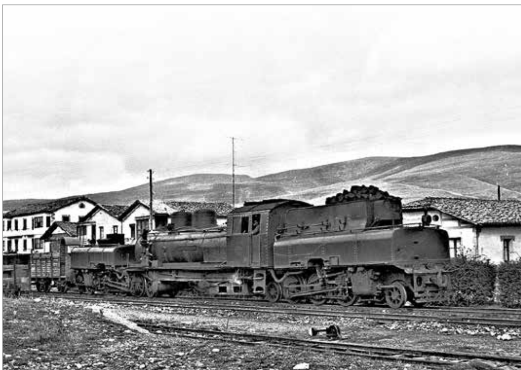
Die Lok Nr. 80 „Venancio de Echevarria“ der FR (El Ferrocarril de la Robla) in Bercedo am 11.9.1961, war eine Meterspurlok, gebaut 1929 von Hanomag, Nr. 10.646, für das ausgedehnte Eisenbahnnetz in Nordspanien. Diese zehnnachsige Garrat (Achsfolge 1'C'1+1'C'1) brachte es auf eine Gesamtlänge über Puffer von 22,8 m und ein Dienstgewicht von 108 t.
