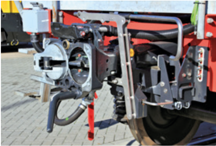
Hier ist das Innere des Scharfenberg-Kupplungskopfes gut erkennbar, rechts der Hebel zum manuellen Entkuppeln.
