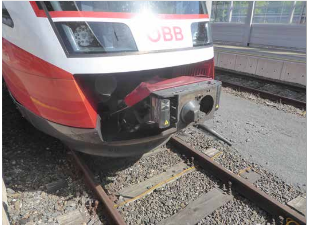
Die Scharfenberg-Kupplung des 5022 030 mit zurückgeschobener Abdeckung (kuppelbereit); Zum Öffnen der Hülle müsste ein Mitarbeiter zwischen die Fahrzeuge treten, was den Vorteil der automatischen Kupplung in Frage stellt. Foto: Willi Saliger
