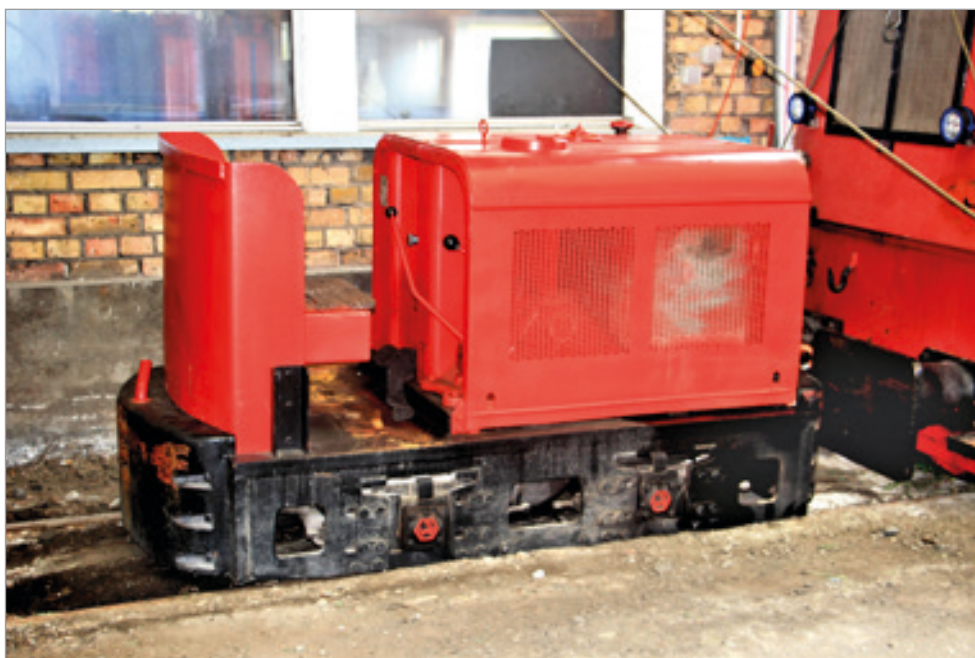
Die kleinste Lokomotive ist der „MAIKÄFER“, eine Jenbacher JW 20 mit der Fabriknummer 2019/1950. Sie war fabrikneu zur IRR gekommen und wird bis heute für leichte Verschubaufgaben in Lustenau eingesetzt. Der 20 PS starke, liegende Einzylinder-Viertakt-Dieselmotor reicht dafür aus. Foto: DI Helmut Bogner, 26.8.2021
