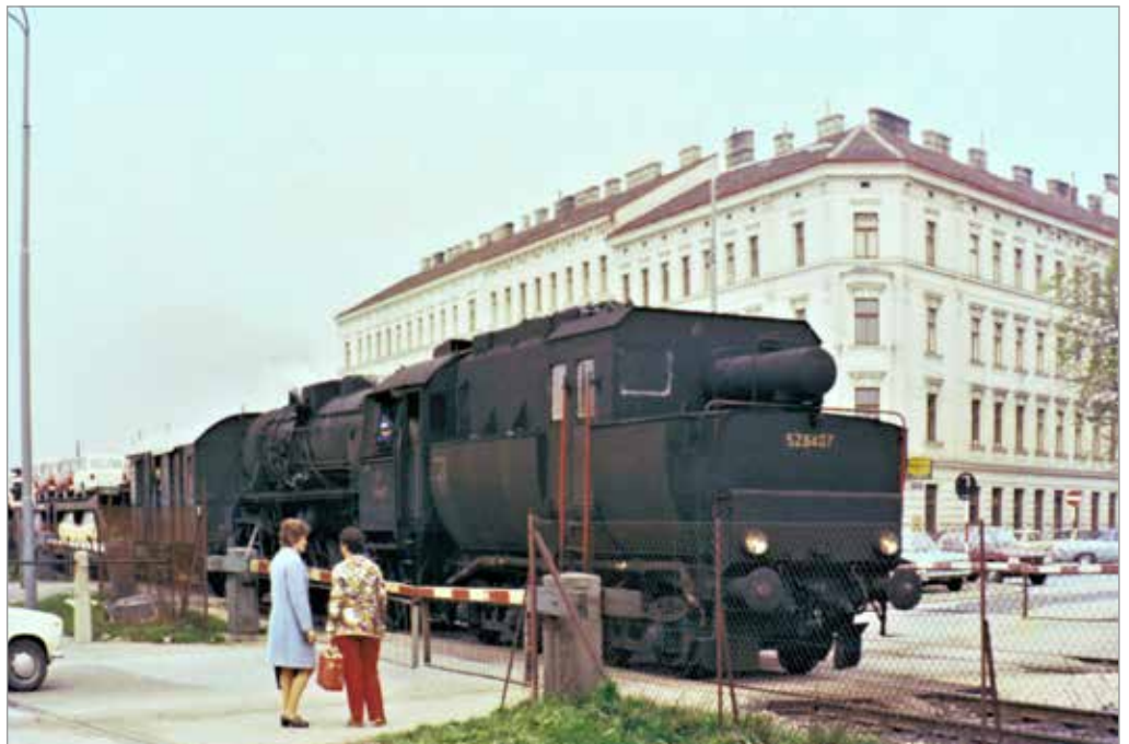
Glücklicherweise drückte Reinhard Capek trotzdem ab, als die 52.6407 Tender voraus die EK Oswaldgasse an der Donauländebahn querte. Dahinter befindet sich der Dienstwagen an der Zugspitze. Die meisten Tender trugen wie dieser einen Kessel für die Wasserenthärtung.
