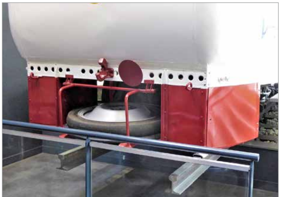
Am Heck des meterspurigen Einrichtungstriebwagens befindet sich neben einem Abschlepphaken auch das Reserverad. Beide Fotos: Gunter Mackinger, 21.5.2022
