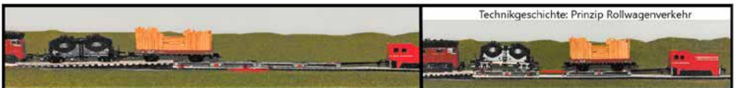
Bild 2: Vielleicht bald schon Technik-Geschichte! Mit Erzeugnissen der ostdeutschen Modellbahnindustrie aus den 60er-Jahren wird das Prinzip des Rollwagenverkehrs nachgestellt. Zuerst werden die Rollwagen zusammengeschoben, sodass gewissermaßen ein provisorisches Gleis entsteht. Immer, wenn ein Normalspurwaggon die Endposition erreicht hat und mit Bremsklötzen gesichert wurde, werden die Rollwagen auseinandergezogen und mit Kuppelstangen verbunden. © Heinz Iwainsky
