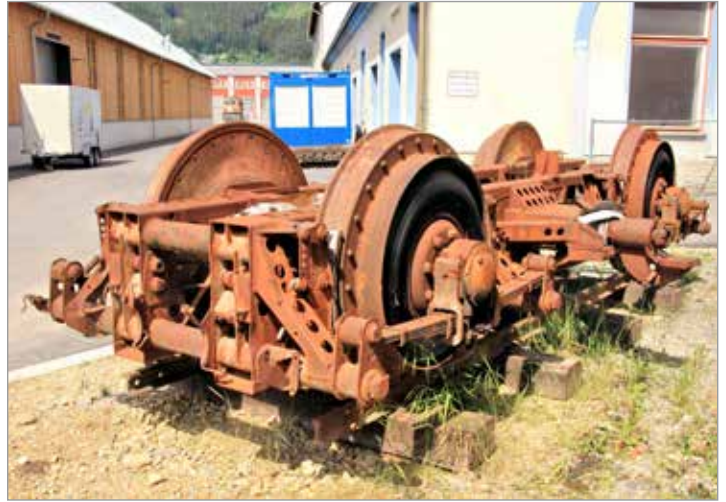
Das erwähnte Drehgestell im Freigelände des Müzzzuschlager Südbahnmuseums. Die Luftreifen sind im Betrieb vollständig aufgepumpt und rollen nicht im Inneren des Eisenbahnrades ab. Wegen des Alters der historischen Reifen hat man aber auf das Aufpumpen verzichtet. Beide Fotos: DI Helmut Bogner, 6.6.2022)
