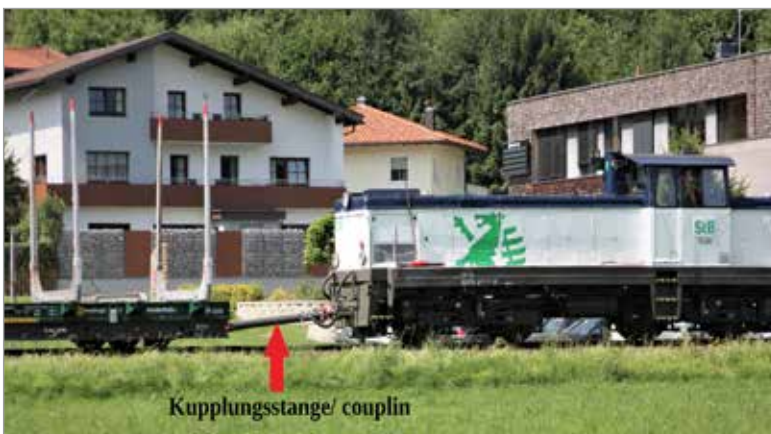
Bild 3: Lokomotive mit leeren Rungenwagen, verbunden mit einer Kuppelstange. Auch die Wagen untereinander werden mit Kuppelstangen verbunden. Foto: Dagmar Iwainsky
