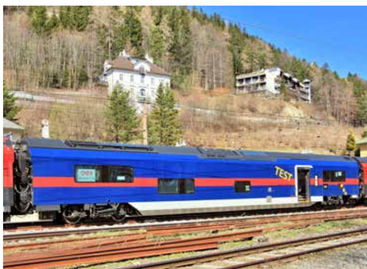
Der mit einem niederflurigen Mittelteil versehene „Multifunktionswagen“ ABbmpvz im Bahnhof Semmering. Der Railjet-Faltenbalgübergang und das Fehlen der Puffer sind gut erkennbar. Foto: DI Helmut Bogner, 12.4.2022
