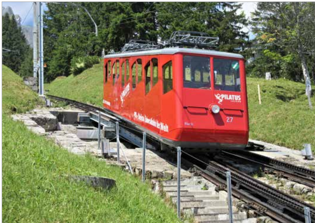
Der Wagen 27 ist am 12.7.2018 mit gesenkten Stromabnehmern auf der oberen Schiebebühne der Zwischenstation Ämsigen auf Talfahrt.
