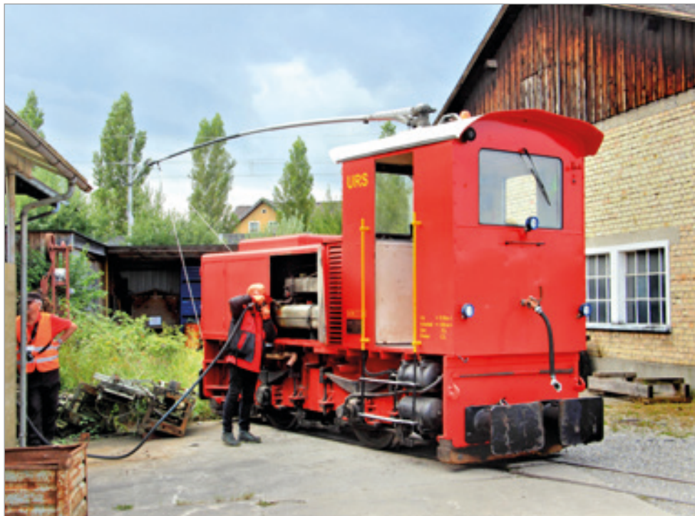
Eine Lokomotive mit Stromabnehmer an der Dieseltankstelle! Nach der Fahrt vom 27.8.2021 wird die Hybridlokomotive „URS“ im Heizhausgelände in Lustenau aufgetankt. Foto: DI Helmut Bogner
