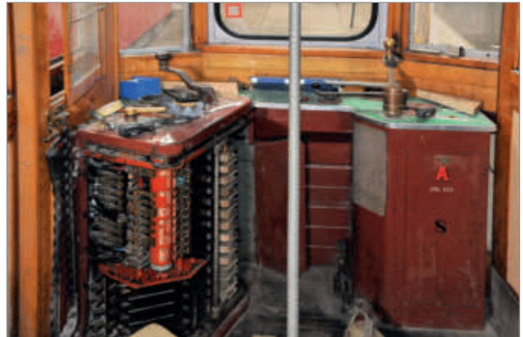
Instandhaltungsarbeiten am Fahrschalter durch unsere Experten. Foto: Roman Lillich, 18.4.2022
