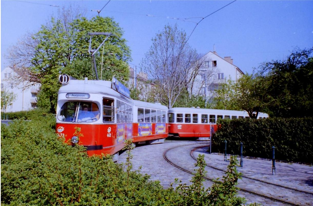
*Nussdorf, Wien-Döbling. Endstelle der Linie "D". Hier fährt ein Fahrzeug der Type E1 4472 (Baujahr 1967 und 1984 erneuert) und Beiwagen Type c3 ... in die Kurve. 4472 wurde 2005 ausgemustert und ist in Krakau im Einsatz. Der Beiwagen (Baujahr zwischen 1959 und 1962 und seither mehrmals erneuert) ebenfalls längst ausgemustert. Die Gleise liegen eingebettet im Kopfsteinpflaster. Das Foto entstand April oder Mai 1994?*
