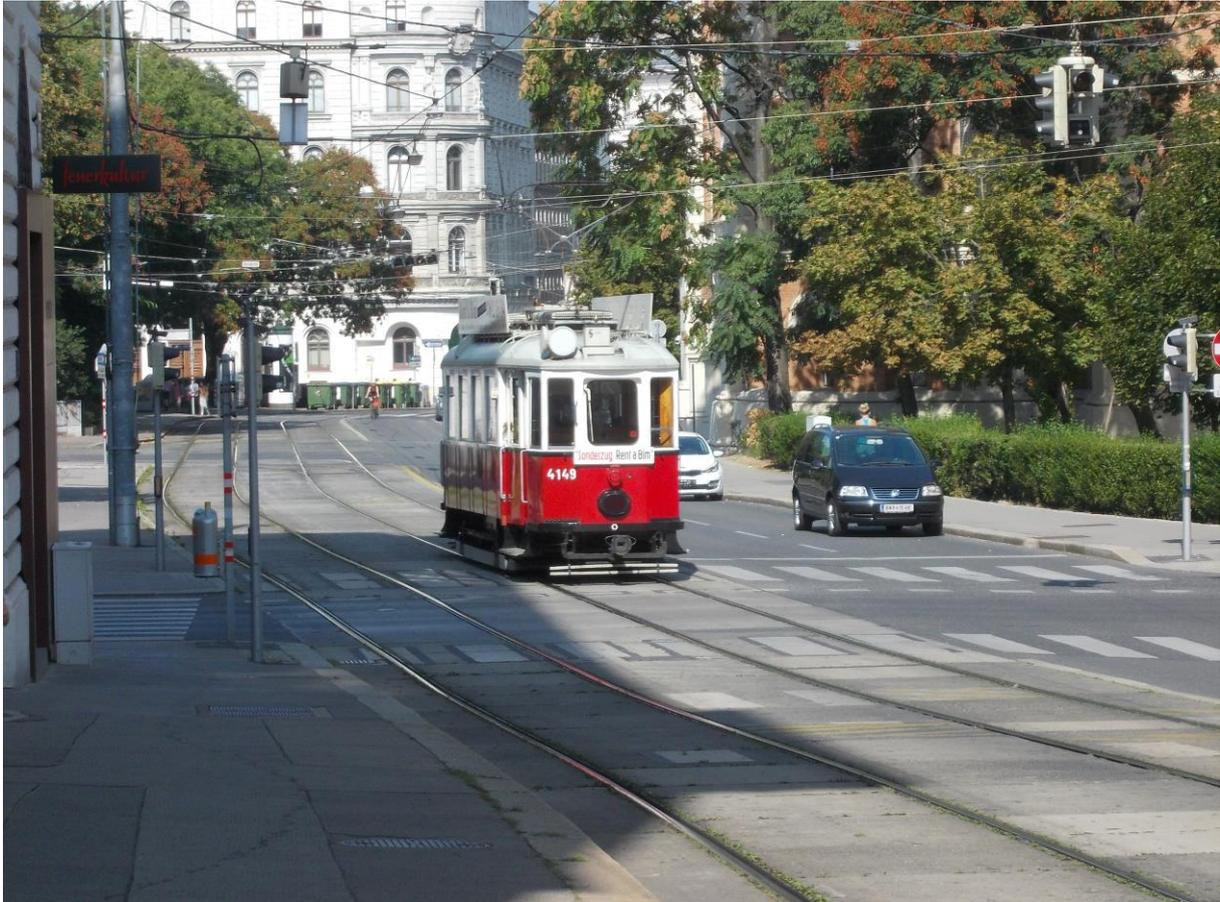
*Solotriebwagen Type M 4149 mit Lyrabügel als Stromabnehmer und dunkler Rotlichtscheibe als Schlusslicht, Richtung Nussdorf, Schlickplatz, Porzellangasse, Wien-Alsergrund (11.09.2016 11:35)*
