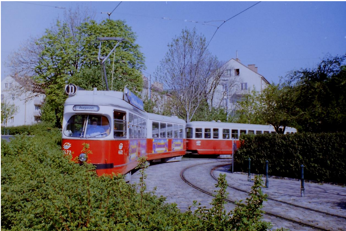
Wien Nußdorf. Endstelle der Linie "D". Hier fährt ein Fahrzeug der Type E1 4472 (Baujahr 1967 und 1984 erneuert) und Beiwagen Type c3 ... in die Kurve. 4472 wurde 2005 ausgemustert und ist in Krakau im Einsatz. Der Beiwagen (Baujahr zwischen 1959 und 1962 und seither mehrmals erneuert) ebenfalls längst ausgemustert. Die Gleise liegen eingebettet im Kopfsteinpflaster. Das Foto entstand April oder Mai 1994?
