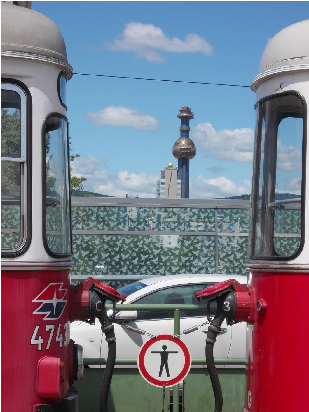
Wien, Friedensbrücke. Blick zur MVA Spittelau, übrigens von Friedensreich Hundertwasser visuell umgestaltet. Links Triebwagen 4743 (Type E1 Baujahr 1971 und ausgemustert 2015, rechts Beiwagen (31. Mai 2016 12:38:32). Über Kupplung und Kabelverbindung rotumrahmte kreisförmige Warntafel, um das lebensgefährliche Durchschreiten über die Kuppelung zu verhindern
