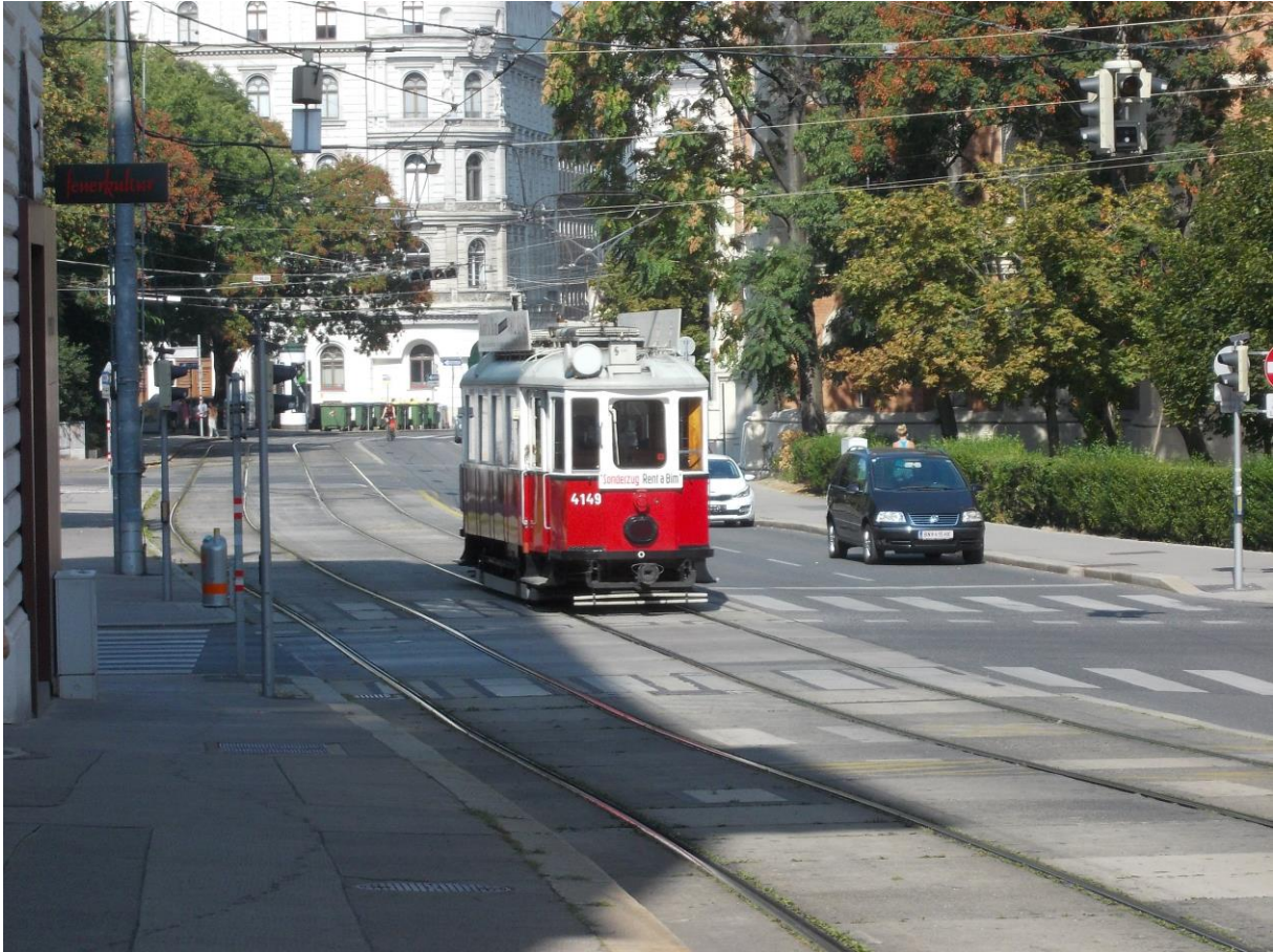
Solotriebwagen Type M 4149 mit Lyrabügel als Stromabnehmer und dunkler Rotlichtscheibe als Schlusslicht, Richtung Nußdorf, Schlickplatz, Porzellangasse, Wien-Alsergrund (11.09.2016 11:35)
