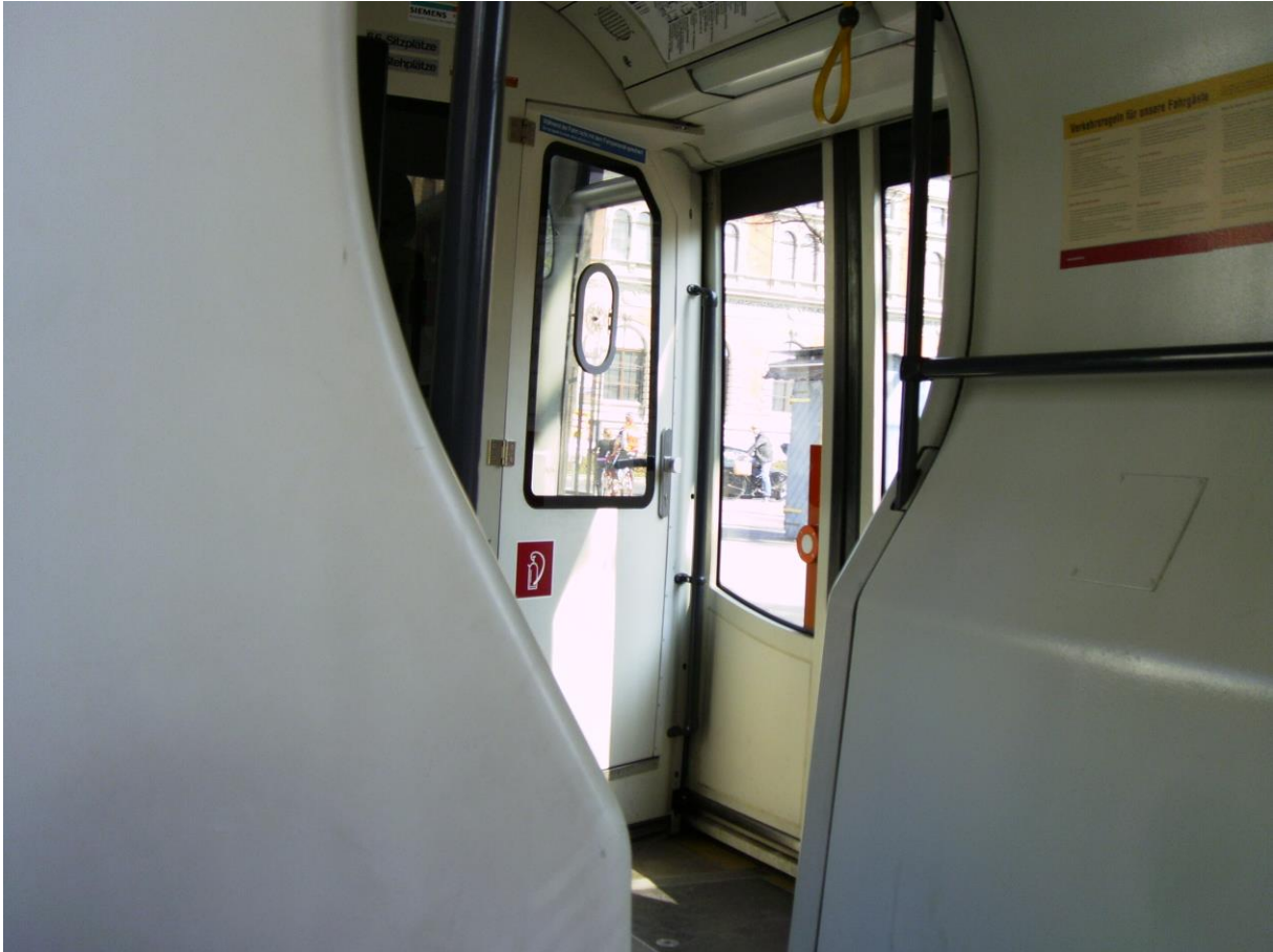
Im ULF. Einfahrt in die Station Börse(?), Schottenring, Wien-Innere Stadt. Blick zur Führerstandtür, die voluminösen Innenkästen beherbergen die leistungsstarken Elektromotoren für die Räder (25. März 2012 13:00)
