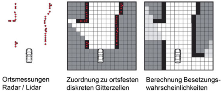
Abb. 20.3 Prinzipbild des Aufbaus einer rasterbasierten Fahrumgebungsrepräsentation. Hier sind im einfachsten Fall nur statische Hindernisse enthalten.
