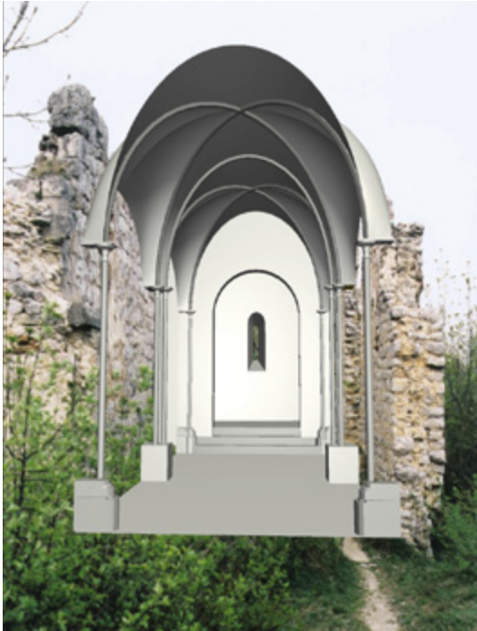
Abb. 141: Rekonstruktion der Annenkapelle in der Burg Starhemberg, integriert in die Baureste
