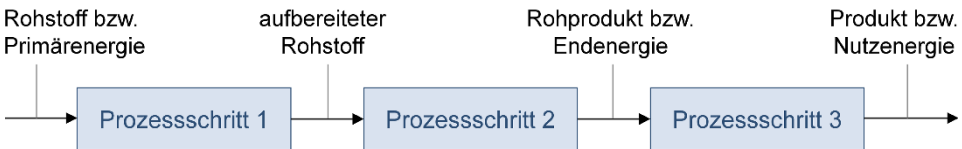
Abbildung 5.1.7: Prinzip einer Bereitstellungskette für Produkte oder Nutzenergie
