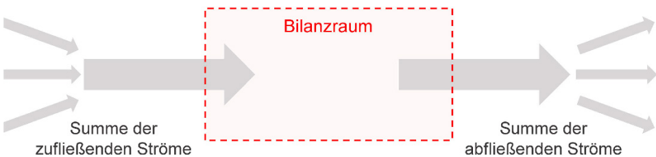
Abbildung 5.2.8: Prinzip der prozesstechnischen Bilanzierung
