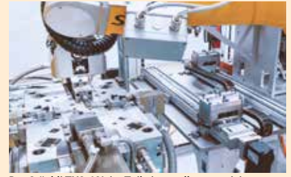
Der Stäubli TX2-60L ist Teil einer vollautomatisierten Maschine, die täglich 600.000 Impfstoffbehälter herstellt. Die Vials werden gehandhabt, bearbeitet und geprüft. Bild: Zahoransky
