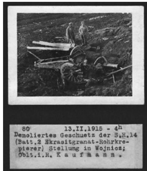
51 Durch Rohrkrepierer zerstörtes Geschütz
