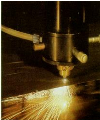
Laserschneiden von Transformator-Bleichen
