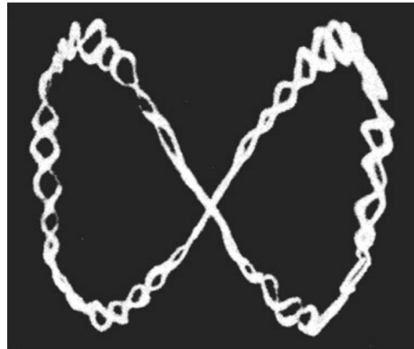
Abbildung 11: Visualisierung der Ionenbewegung in einer Paulfalle. 48
