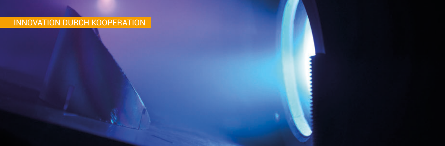
Kombinierte Magnetron/Surfatron-Abscheidung von TiO 2 im metallischen Modus Bild: © Universität Budweis/Labor für Angewandte Plasmaphysik und Nanostrukturen
