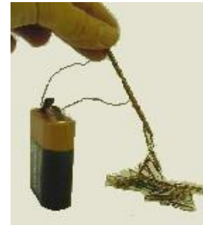
Strom durchflossener Leiter ( links ) und Strom durchflossene Spule ( oben ).
