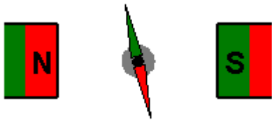
Kompassnadel (Permanentmagnet!) in einem Magnetfeld
