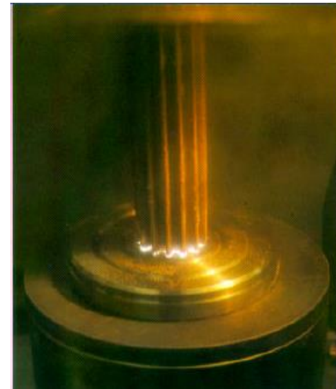
Funkenerosive Zahnkranzherstellung
